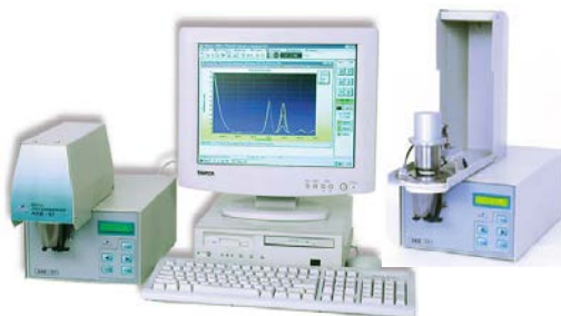
Рис. 2. Вольтамперометрический анализатор «АКВ-07-МК» для определения содержания токсичных элементов
